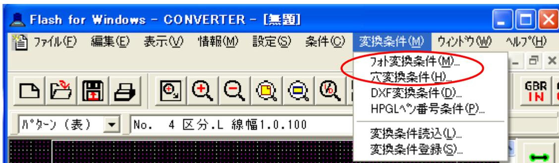
フォトデータと穴データ変換条件を設定します。
